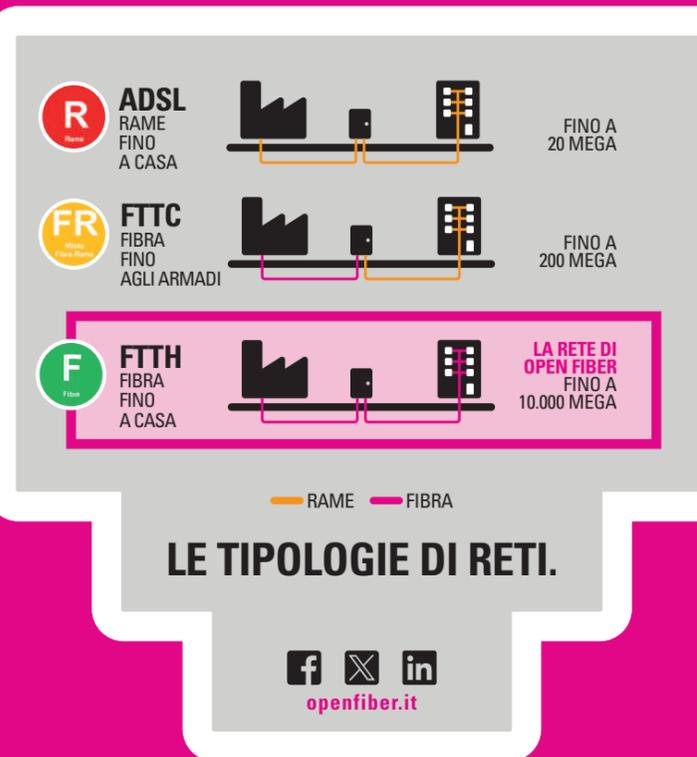
Questa rappresenta la principale differenza con le altre tecnologie di rete sia in banda larga che in banda ultra-larga, dove la fibra si ferma alla centrale (ADSL) o al cabinet in strada (FTTC, Fiber To The Cabinet) per poi arrivare a casa dell'utente finale sul rame, con performance notevolmente peggiori in termini di velocità e stabilità della connessione.
